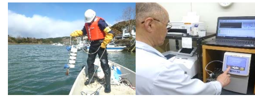
採水・採泥器等を使用して試料を採取します。また、機器を用いて水温や濁度等の現地観測を行います。
