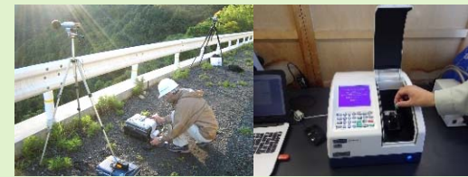
道路計画や維持管理に必要な自動車の交通量や自動車交通騒音・振動等を把握します。
